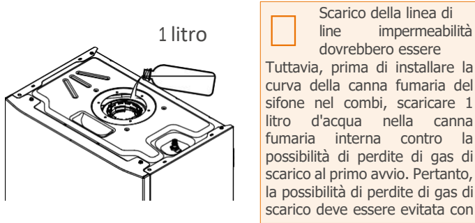
Figura 22 Riempimento del sifone di condensa
