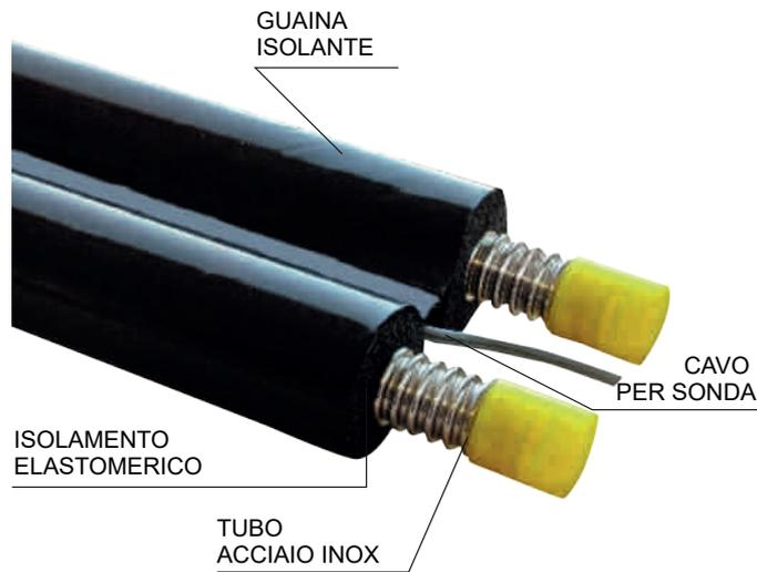
Le tubazioni di acciaio inox corrugato accoppiate andata + ritorno, costituiscono un sistema completo di Bi-tubi coibentati per gli impianti solari. Composto da doppio tubo con una flessibilità elevata che gli deriva dalla corrugazione, realizzato in Acciaio inossidabile di tipo austenitico INOX AISI 316L.
