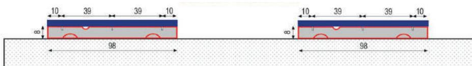
Questo prodotto è stato progettato per l'ancoraggio di strutture e/o di moduli fotovoltaici su tetti piani e su terreni battuti con pendenza max 5°, realizzato totalmente in calcestruzzo durabile nel tempo.
