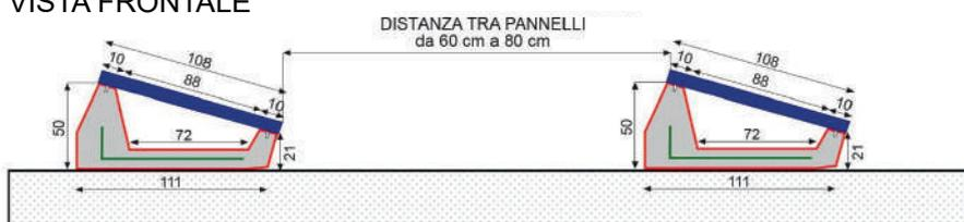
E' stato progettato per l'ancoraggio di moduli fotovoltaici su tetti piani e su terreni battuti con pendenza max 5°, realizzato totalmente in calcestruzzo durabile nel tempo.
