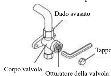
12. Utilizzando una chiave esagonale, aprire completamente sia la valvola di alta pressione che quella di bassa pressione.
