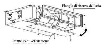
Piegare il pannello di ventilazione posteriore di 90 gradi lungo la linea tratteggiata in un pannello di ventilazione discendente. (alcuni modelli)
