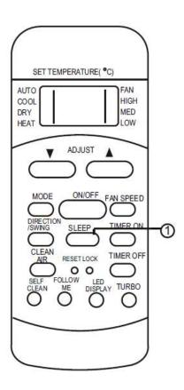
La funzione SLEEP permette all'unità di aumentare automaticamente (in raffreddamento) o diminuire (in riscaldamento) di 1°C all'ora per le prime due ore di funzionamento e di tenere costante la temperatura per le successive 5 ore, dopo di che l'unità arresterà automaticamente il funzionamento.
