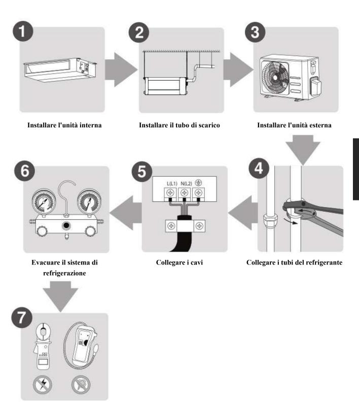
Eseguire un test di funzionamento
