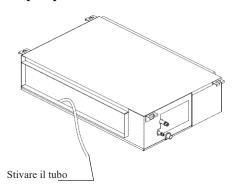
Riempire il serbatoio con 2 litri di acqua. Controllare che il tubo di scarico non sia ostruito.
