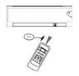
Tenere il telecomando dove il segnale ad infrarossi possa raggiungere il ricevitore dell'unità interna.
