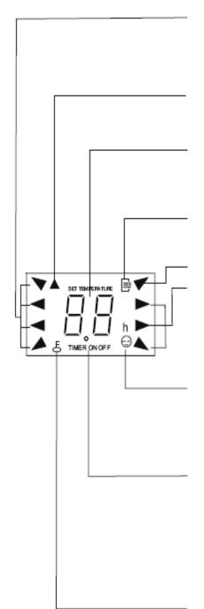
**MODE DISPLAY:** Visualizza la modalità corrente selezionata. Compresi AUTO, COOL, DRY, HEAT (modelli solo riscaldamento) e FAN.
