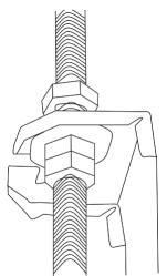
Montare l'unità interna sui bulloni a vite sospesi e bloccarli in posizione. Posizionare l'unità interna in piano utilizzando un indicatore di livello per evitare perdite.
