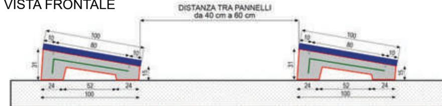
E' stato progettato per l'ancoraggio di moduli fotovoltaici su tetti piani e su terreni battuti con pendenza max 5°, realizzato totalmente in calcestruzzo durabile nel tempo.
