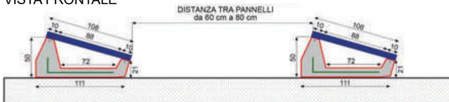
E' stato progettato per l'ancoraggio di moduli fotovoltaici su tetti piani e su terreni battuti con pendenza max 5°, realizzato totalmente in calcestruzzo durabile nel tempo.
