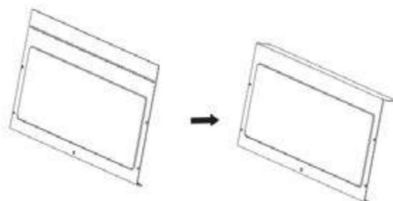
2. Modificare le posizioni di montaggio del pannello di ventilazione e della flangia di ritorno dell'aria.
