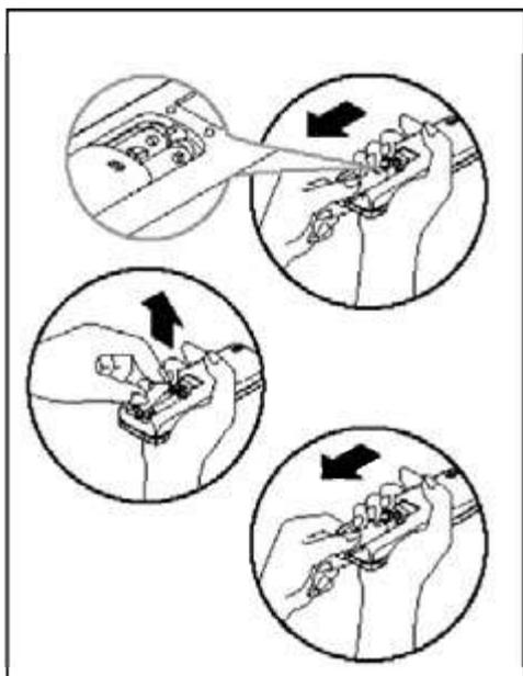
(1) Se il display del telecomando non funziona, bisogna sostituire le batterie del telecomando.
