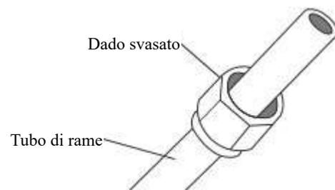
4. Rimuovere il nastro in PVC dalle estremità del tubo quando si è pronti ad eseguire la svasatura.
