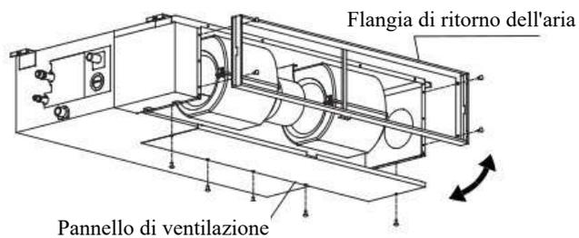
Piegare il pannello di ventilazione posteriore di 90 gradi lungo la linea tratteggiata in un pannello di ventilazione discendente. (alcuni modelli)
