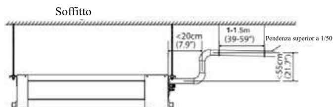
**NOTA:** Quando si collegano più tubi di scarico, installare i tubi come illustrato.
