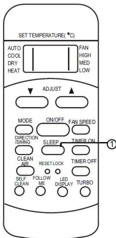
La funzione SLEEP permette all'unità di aumentare automaticamente (in raffreddamento) o diminuire (in riscaldamento) di 1°C all'ora per le prime due ore di funzionamento e di tenere costante la temperatura per le successive 5 ore, dopo di che l'unità arresterà automaticamente il funzionamento.
