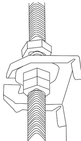
9. Montare l'unità interna sui bulloni a vite sospesi e bloccarli in posizione. Posizionare l'unità interna in piano utilizzando un indicatore di livello per evitare perdite.
