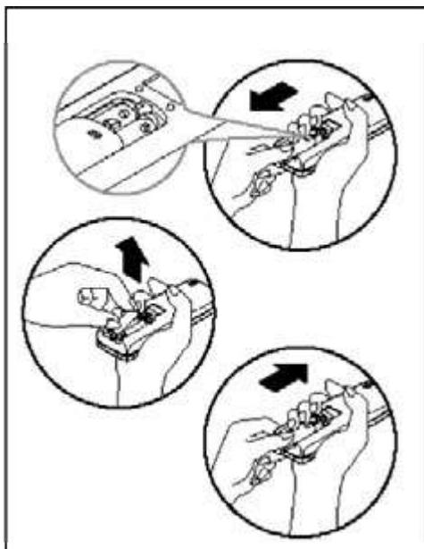
(1) Sono necessarie due batterie alcaline (R03/LR03 x 2) per il telecomando.
